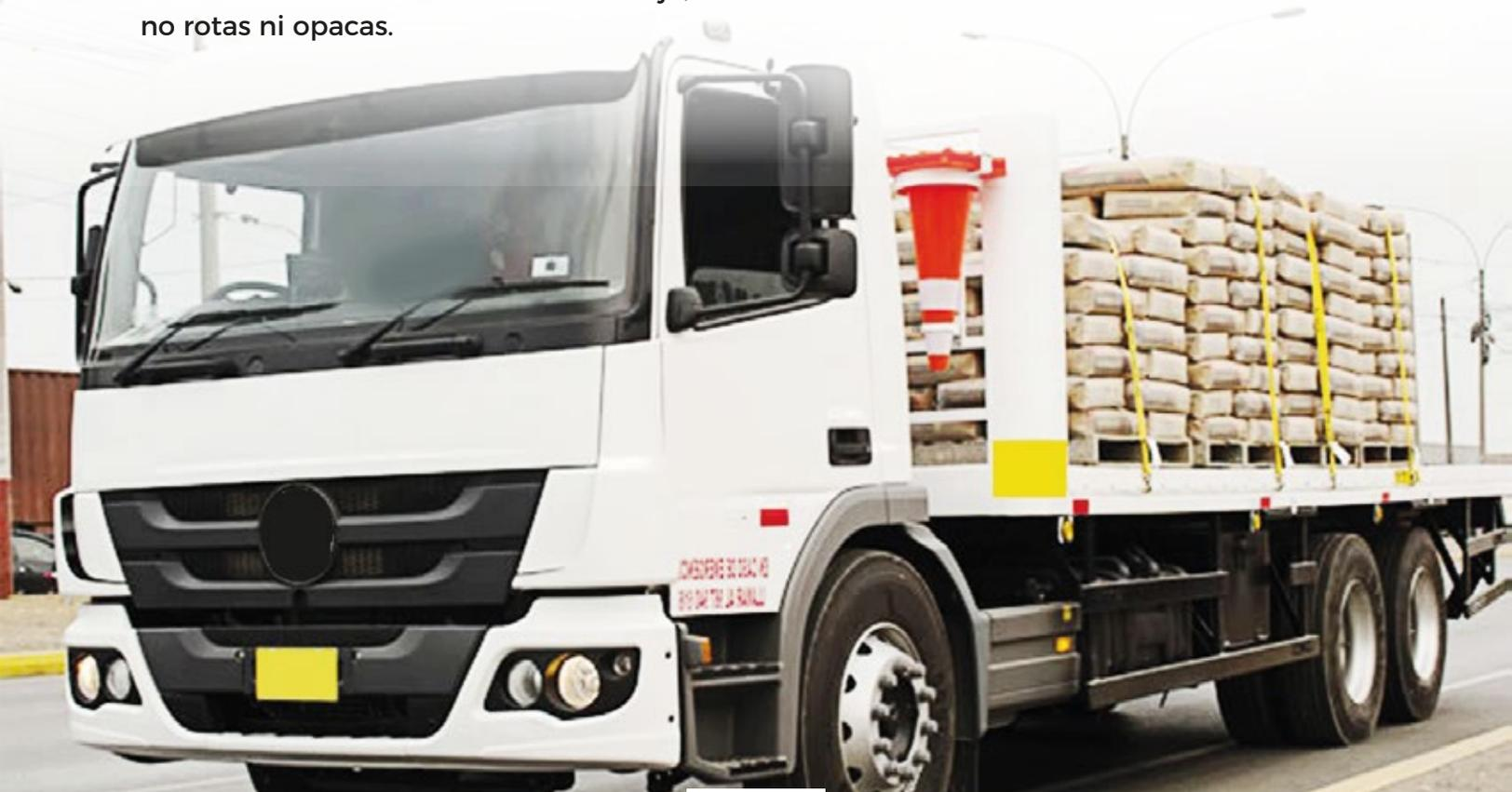
**10. Torreta:** instalada en la parte superior del camión, con lámparas giratorias de 360° de color ámbar.
