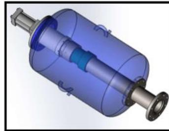
Cañón de limpieza para el mono del quemador 481-QE1 marca IGS con un nuevo diseño de limpieza donde se adapta un pistón en el interior del tanque el cual tiene como objetivo liberar el aire en cada disparo.
