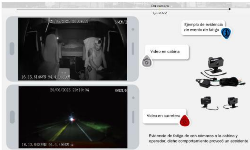
Alerta de fatiga de cámara GPS instalada.
