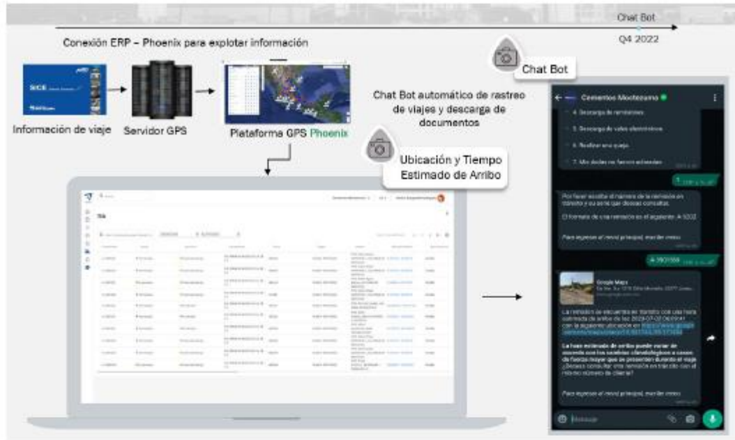
Chat Bot automatizado con servidor de ERP y GPS
