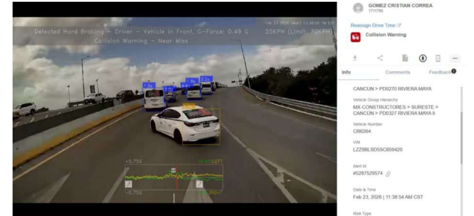
Imagen de video en donde se valida que : el vehículo tercero “invade” la zona de seguridad adelante del CR (color amarillo en recuadro), el sistema da una alerta de colisión en cabina y el operador realiza un frenado brusco justificado.
